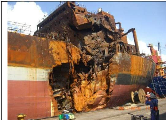
圖 4「立善輪」撞船後被拖往新加坡入塢修理
