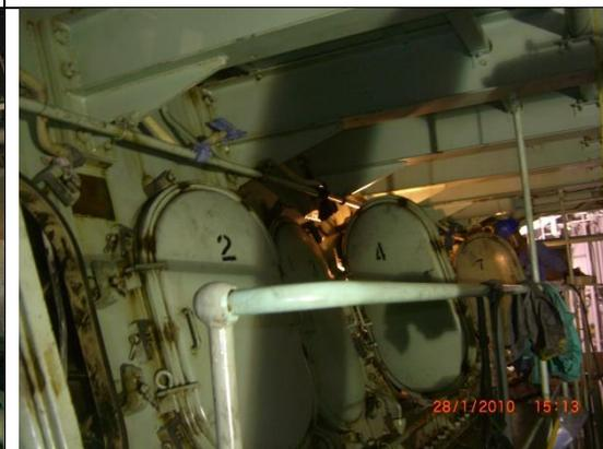
圖 9「立善輪」機艙底層主機檢查修理
