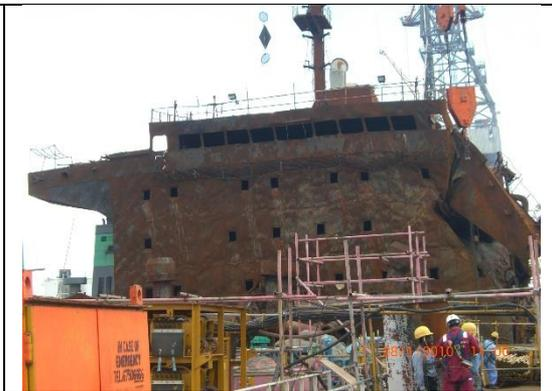
圖 5「立善輪」撞船後被拖往新加坡入塢修理住艙燒毀情形
