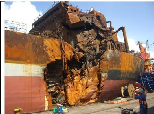
圖 9 『立善輪』撞船後被拖往新加坡入塢修理
