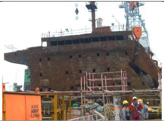
圖 10 『立善輪』撞船後被拖往新加坡入塢修理住艙燒毀情形
