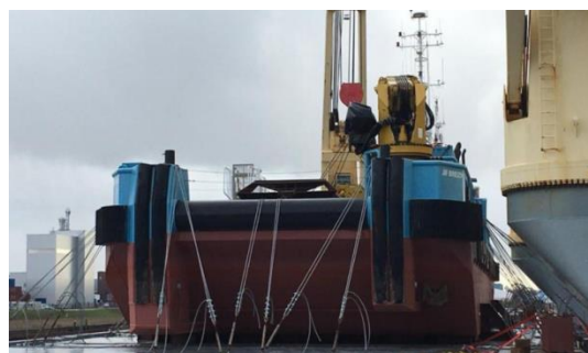
圖 5-1 短程的 預造船段 運輸，圖 5-2 這是一艘裝載在甲板上的綁紮現場勘驗(裝於底艙)。海工船的綁紮現場。
