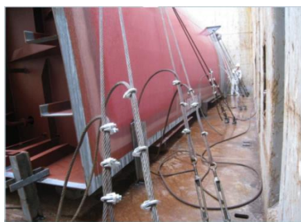
圖 5-1 短程的 預造船段 運輸，圖 5-2 這是一艘裝載在甲板上的綁紮現場勘驗(裝於底艙)。海工船的綁紮現場。
