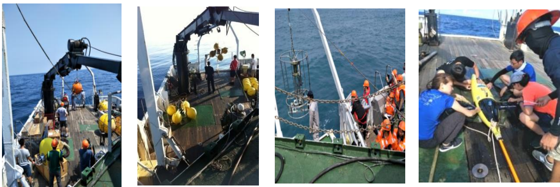
圖 18 船測實驗：放錨碇、繫海流偵測儀、CTD 偵測水溫、鹽度、水壓、滑翔翼自主蒐集水文
