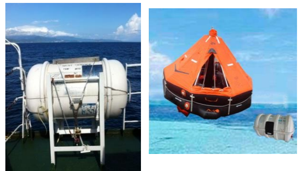
圖 44 當船沉沒，救生筏會自動脫離浮出水面，受外殼保護，不可能有擦碰、破損痕跡
