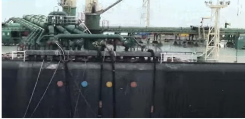
準備接在輸油歧管(manifold)上的四根貨油軟管
