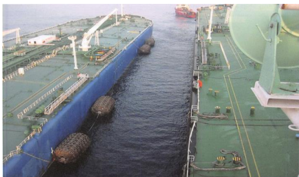
照片顯示：子船處於輕載狀態下，由母船(STBL)事先繫固好兩對 Yokohama 碰墊。
