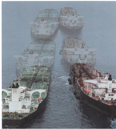
照片-7 當兩船接近時，兩船間應盡可能平行，此時可利用艏推與主機調整船位。
