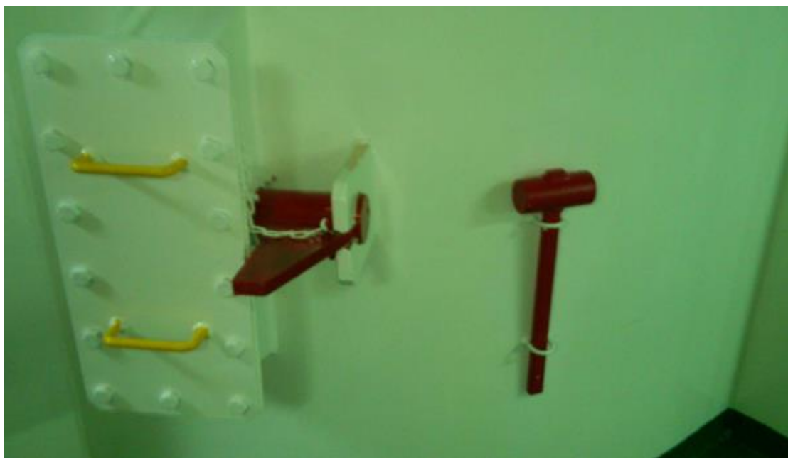
圖八：Bosun Store 內的 Chain Locker 外壁， retaining Pin 、 Split Pin 以及大榔頭。(照片來源：Capt. James Chan)
